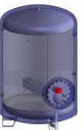
Réchauffage de 10 à 60°C en 6H Thermostat (triphasé puissance ≤ 20 kW) Réchauffeur : RP=90/70°C ECS=10/60°C
